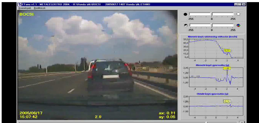
14. kép 2 s-mal a fékezés megkezdése után; v=8,3 \text{ km/h} ; a=+10 \text{ m/s}^2
