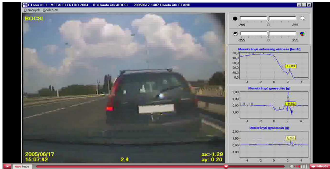
16. kép 2,4 s-mal a fékezés megkezdése után; v=12,8 km/h; a=-5,9\text{m/s}^2
