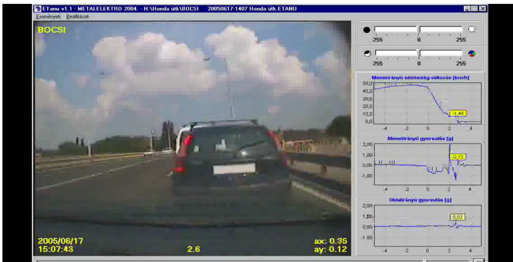
18. kép 2,8 s-mal a fékezés megkezdése után; v=-1,44 km/h; a=-1,2\text{m/s}^2
