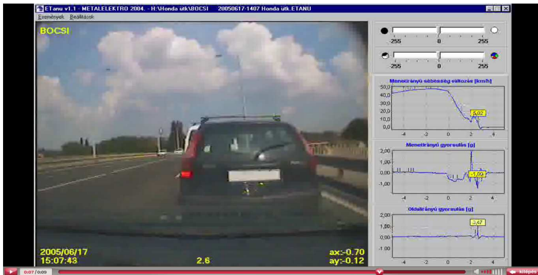
17. kép 2,6 s-mal a fékezés megkezdése után; v=5,02\text{km/h} ; a=-10\text{m/s}^2
