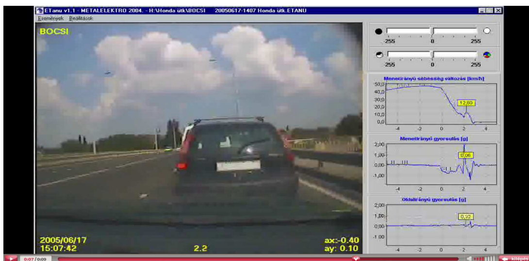
15. kép 2,2s-mal a fékezés megkezdése után; v=12,8 \text{ km/h} ; a=+0,6 \text{ m/s}^2
