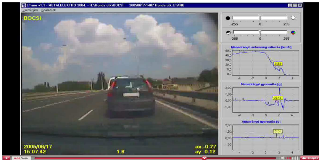
13. kép 1,8s-mal a fékezés megkezdése után; v=9,23 \text{ km/h} ; a=-4,3 \text{ m/s}^2
